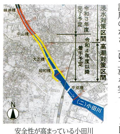
小田川の大正橋から上流の浸水対策はこれまで護岸のかさ上げ工事を実施してきましたが、あと0・15kmを残すのみとなりました。（バス停2箇所のパラペック橋から下流対策区間約3・5kmの4車線化が完成度実施予定）また大正橋から下流部分の高潮対策区間約0・7kmにつ
